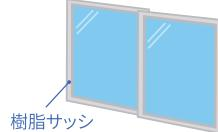
窓のサッシを熱の伝わり方がアルミの1/1000である樹脂サッシへ交換することで断熱効果を高めます。
