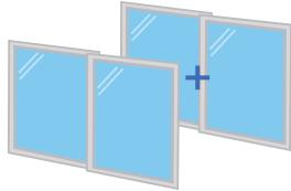
窓の内側にもう一枚窓を取り付け二重にして断熱効果を高めます。
