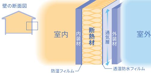
断熱材も快適な住宅の要素です。窓の次に多くの熱が出入りするのは壁。そこに使う断熱材の性能や厚みによって快適性は変わります。屋根、床にも設置し断熱材で建物全体を覆うことで熱の逃げる場所を減らすことが大切です。
